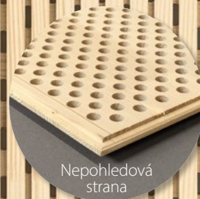
Profil S/L – pohledová strana drážkování 4/12, nepohledová strana vrtání 16/32-32
